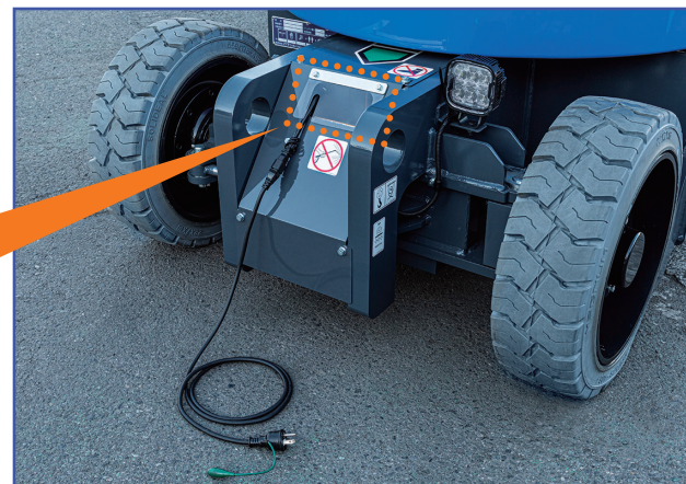
≫充電プラグ+延長ケーブル 03 走行中における充電ケーブルの引きずりを防ぐため 着脱式の延長ケーブルを搭載。
