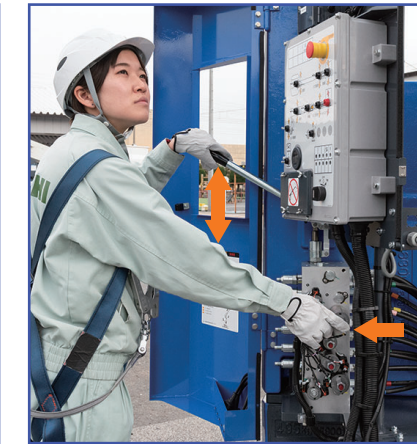
≫非常降下装置 04 バッテリー切れなどの発生時に、作業床をハンドポンプで下ろすことが可能。
