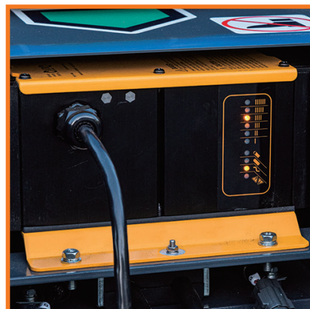
≫充電状態表示灯 表示灯の点灯・点滅で、充電状態を表示。 ※撮影用にカバーを外しています。
