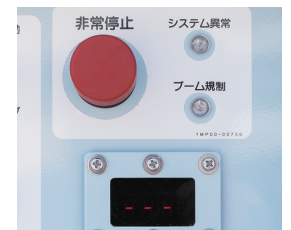
非常停止スイッチ (エンジン停止装置と兼用)
