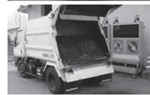
排出は、水平押し式(排出板式)で安全でスムーズ。
